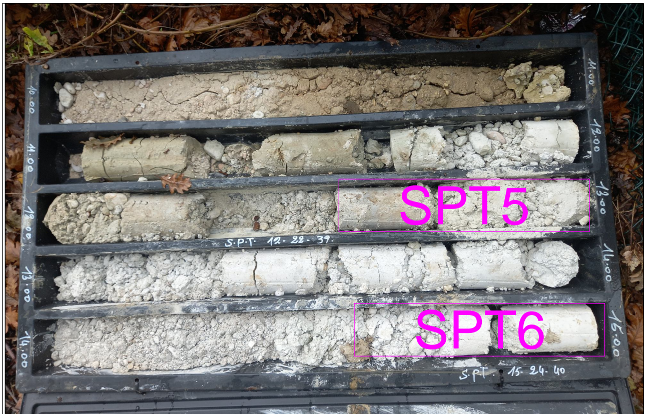
Foto 4: Stratigrafia sondaggio S1, da 10.0 a 15.0 ml..
