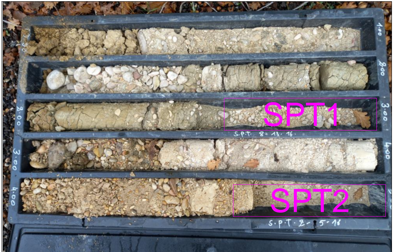
Foto 2: Stratigrafia sondaggio S1, da 0.0 a 5.0 ml..
