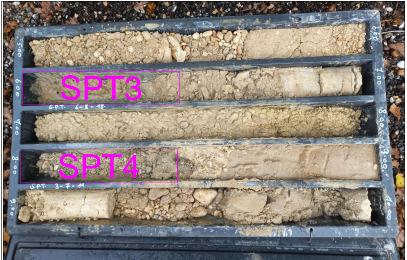
Foto 3: Stratigrafia sondaggio S1, da 5.0 a 10.0 ml..
