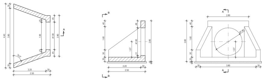
ARMATURA MANUFATTO DI SBOCCO/IMBOCCO - CIRCOLARE Ø1000mm
