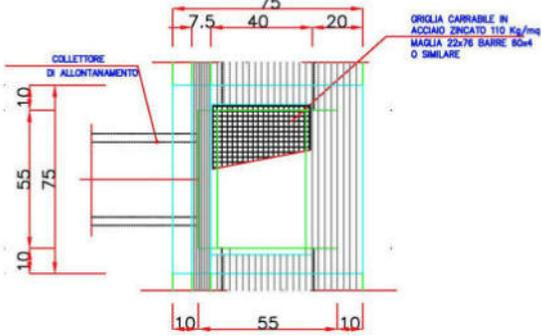
esterni tramite un sistema di canalizzazione sul ciglio strada che porta le acque sul reticolo idrografico esistente
