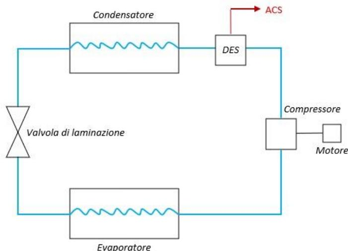
Il gruppo frigorifero a recupero totale, nel senso proprio del termine, recupera completamente il calore rilasciato dal fluido refrigerante durante il desurriscaldamento e la conseguente condensazione. Ciò è possibile
