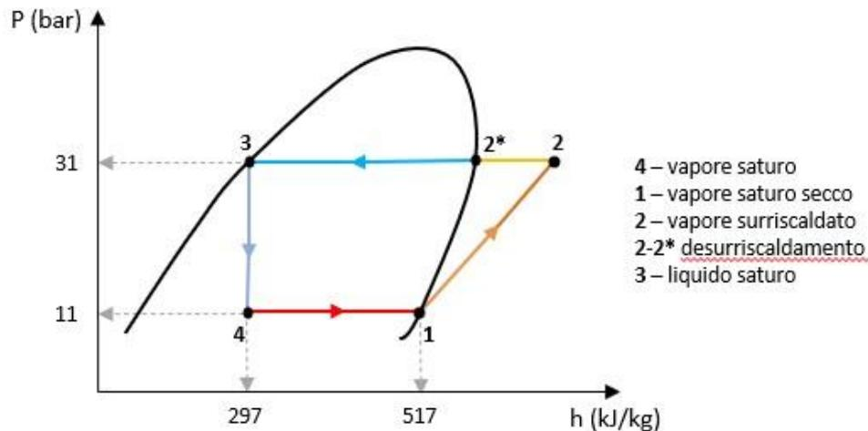
Fissando la pressione a 11 bar, l'R32 evapora alla temperatura di circa 10°C, portando poi la pressione a 31 bar condensa alla temperatura di circa 50°C.
