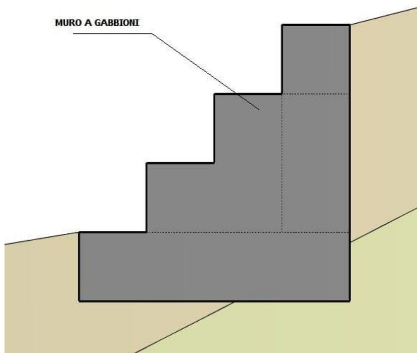
Il filo utilizzato nella produzione dei gabbioni (a basso tenore di carbonio) può essere rivestito, con Galfan (lega eutettica di Zinco-Alluminio – 5%) secondo [UNI EN 15646](#) in relazione alle caratteristiche di durata dell'opera e del grado di aggressività ambientale.
