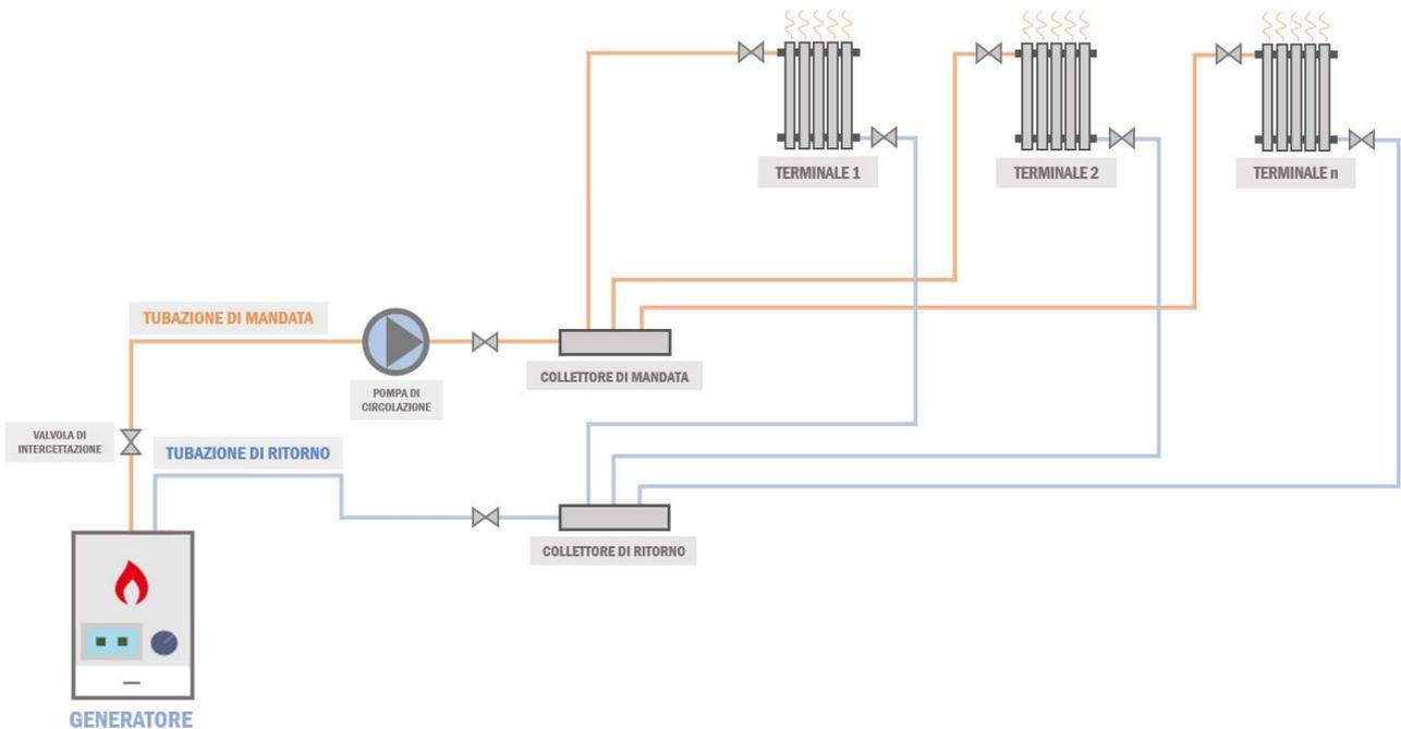
Nel caso di impianto autonomo, abitazione singola, il numero di collettori da predisporre sarà funzione della superficie calpestabile. Per gli impianti centralizzati invece, è previsto un collettore al servizio di ciascun appartamento.
