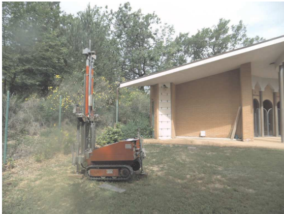
foto 1: esecuzione prova penetrometrica dinamica super pesante Dpsh1
