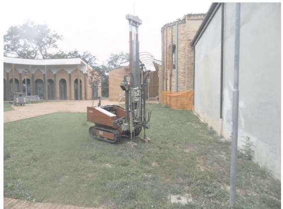
foto 2: esecuzione prova penetrometrica dinamica super pesante Dpsh2
