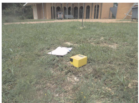
foto 6: esecuzione rilievo sismico passivo con tecnica HGRV e registrazione mediante tromografo digitale.
