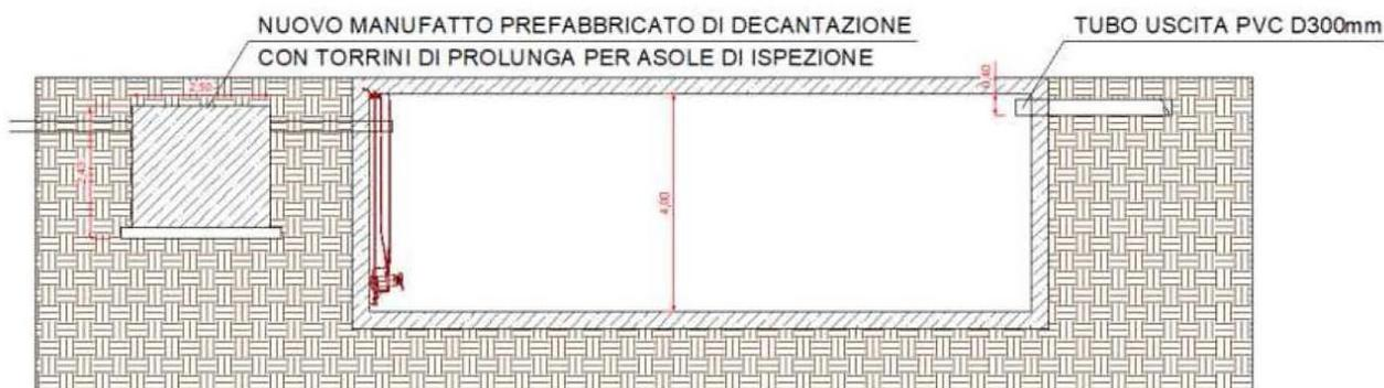
Figura 125: Schema installazione vasca decantazione
