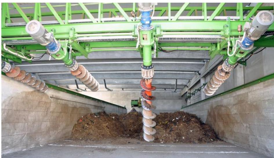
*Figura 88: Carroponete con 4 Coclee "gemello" a quello dell'Impianto di San Biagio Fermo*
