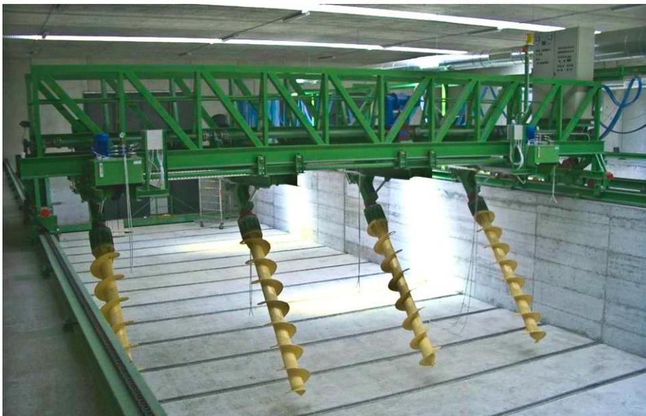
*Figura 87 Carroponte con 4 Coclee, "gemello" a quello in funzione nell'Impianto di San Biagio Fermo*
