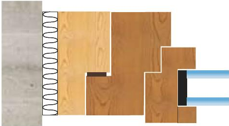
USB Foam per l'isolamento termico ed acustico del giunto di posa tra falso telaio e muratura
