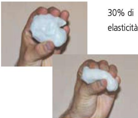
USB Foam per l'isolamento termico ed acustico del giunto di posa tra falso telaio e muratura
