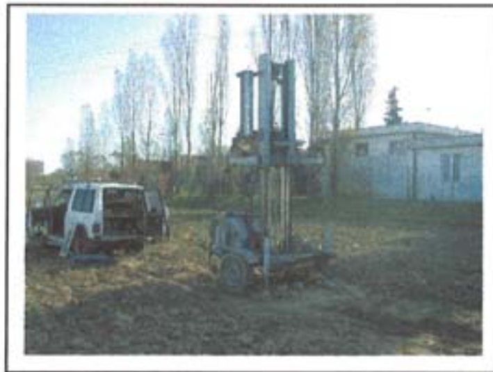
Foto 1 _Realizzazione prova DPSH n°1.
