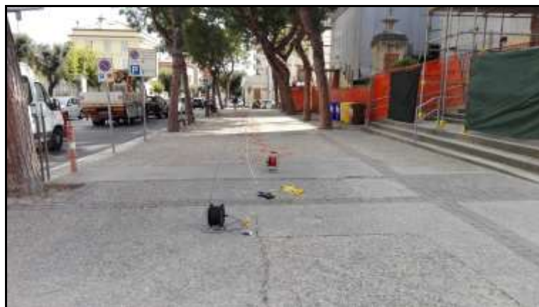
Esecuzione indagine geofisica con metodologia MASW 1
