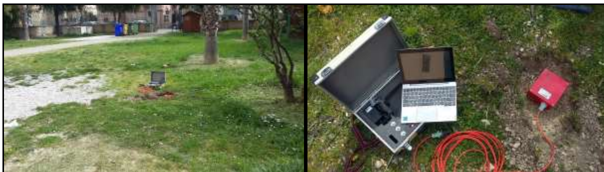
Esecuzione dell'indagine geofisica con metodologia HVSR – TR1
