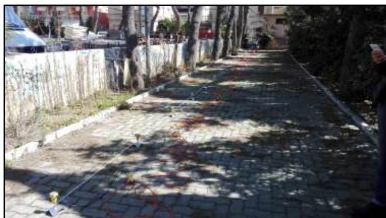
Esecuzione indagine geofisica con metodologia MASW 2
