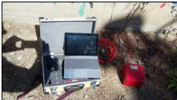
Esecuzione dell'indagine geofisica con metodologia HVSR – TR2
