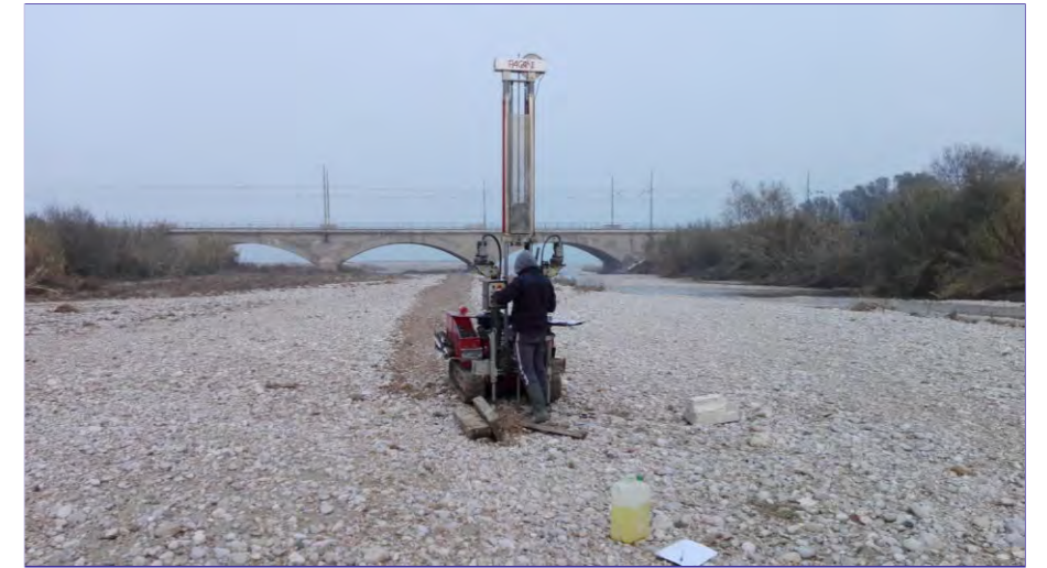
Foto 3 - Esecuzione prova penetrometrica dinamica DPHS (P3)
