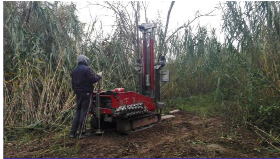
Foto 2 - Esecuzione prova penetrometrica dinamica DPHS (P2)
