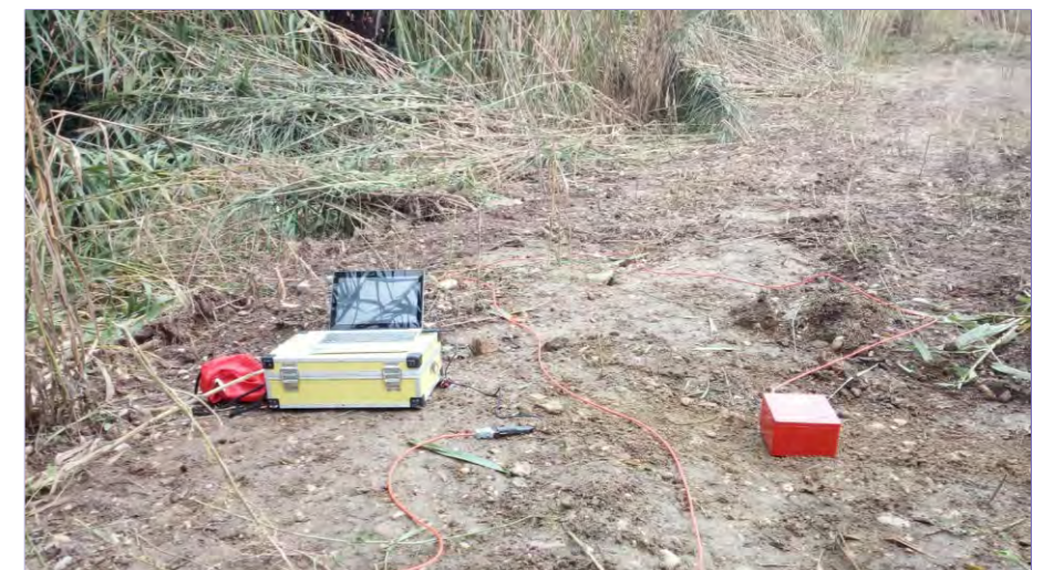
Foto 9 - Esecuzione prova sismica (Tr4) mediante metodologia HVSR
