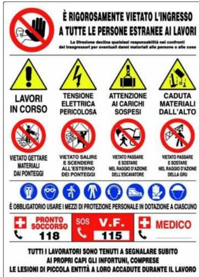
Figura 9 Segnaletica tipo di cantiere
