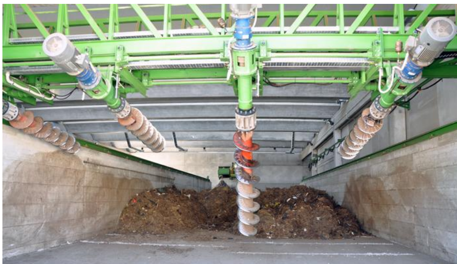
Figura 6: Carroponte con coclee
