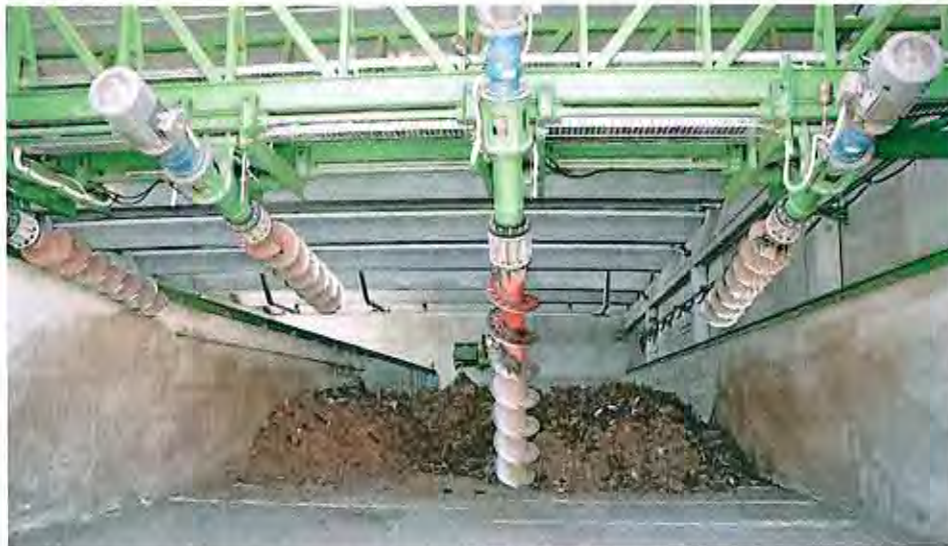
Figura 87: Carroponte con 4 Coclee "gemello" a quello dell'Impianto di San Biagio Fermo
