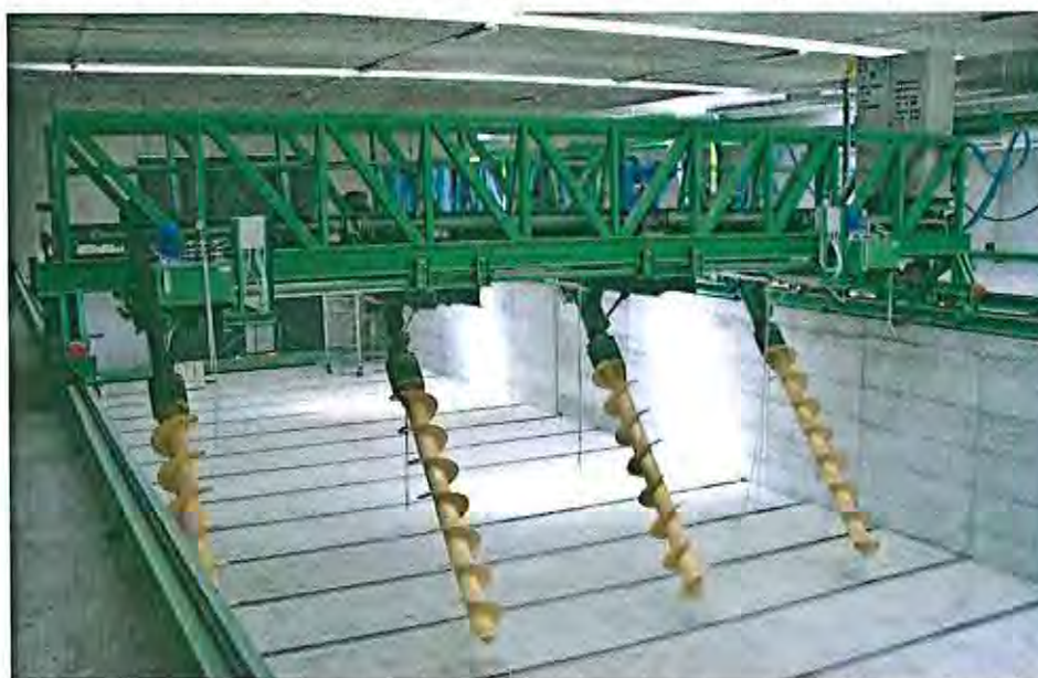
Figura 83 Carroponte con 4 Coclee, "gemello" a quello in funzione nell'Impianto di San Biagio Fermo
